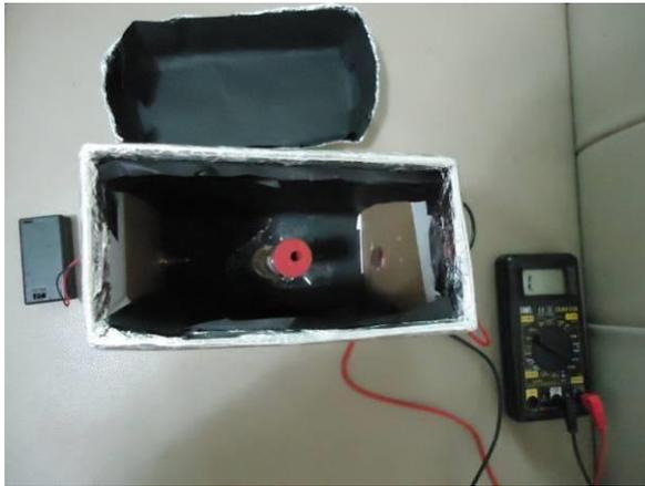
將油品試管置入透光性測量盒中
