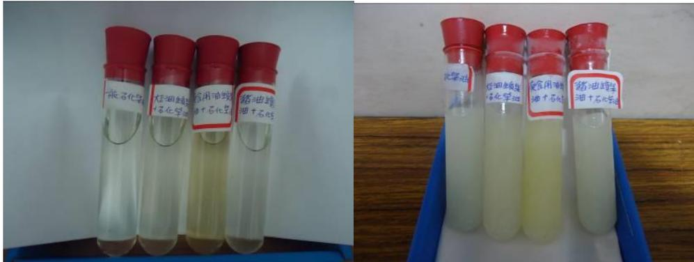
B10 和 B20 生質柴油降溫前後外觀變化(左圖室溫、右圖雲化後)
