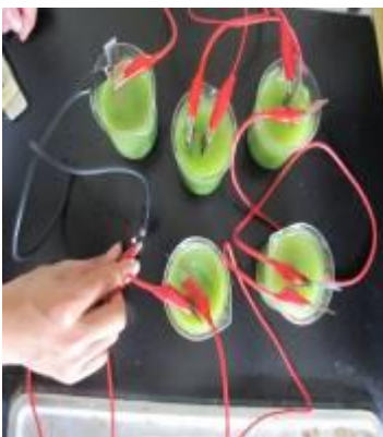
圖.串聯 5 個樹葉電池，燈泡發亮情形
