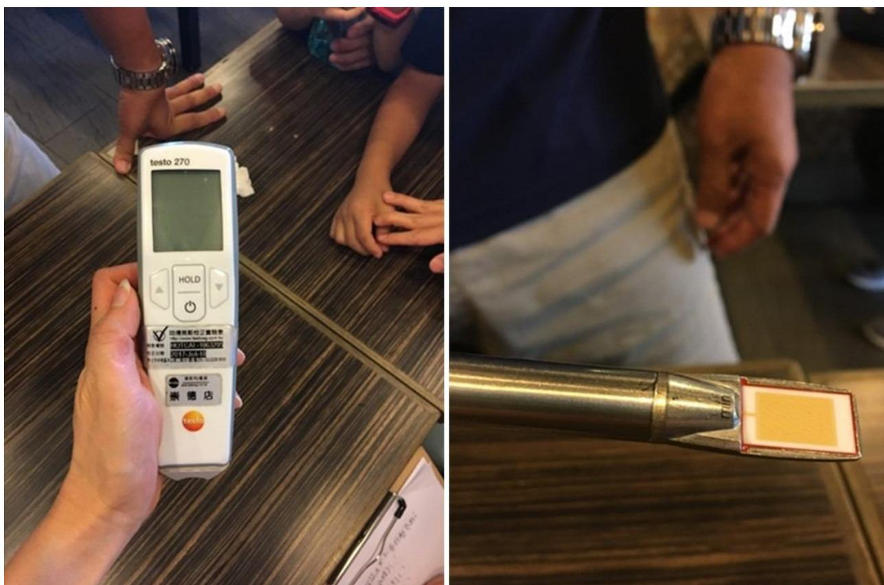
圖 14 油品測試儀器是利用前方的感測晶片去檢測出油的酸化程度和溫度
