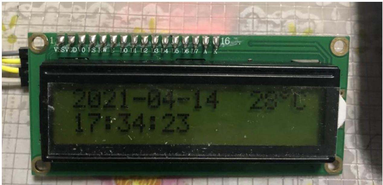
圖 11 LCD 螢幕上面可以顯示時間、日期、還有溫度功能
